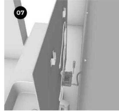
Abra la caja de conexiones entregada con el espejo, todos los conductores deben ser accesibles. Dependiendo del tipo de luz en su espejo, tendrá dos cables para conectar.
