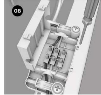
Conecte primero el cable neutro (azul) y posteriormente la fase (rojo, negro o marrón). Cierre la caja de conexiones para que permanezca aislada y protegida. **\*Nota:** En la mayoría de los casos, la luz del espejo no tiene un conector a tierra, ya que se dice que tiene "doble aislamiento".
