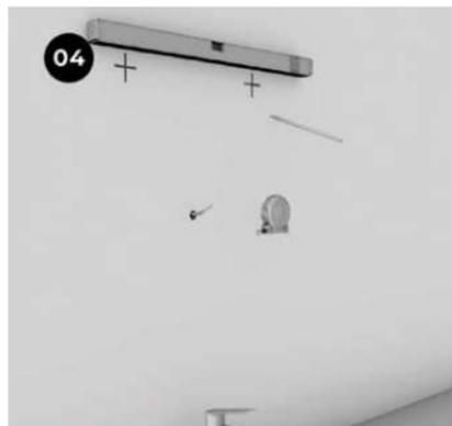
Los espejos iluminados se fijan a la pared con tornillos. Consulte los soportes traseros del espejo para marcar los orificios en la pared, verifique la horizontalidad con un nivel. Asegúrese de que el espejo esté centrado con respecto al lavabo o pila.
